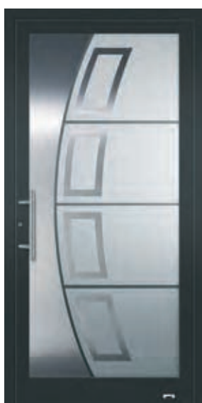
5457 Verglasung: Wärmeschutzisoliertes, vorne: VSG beschichtet, Mitte: ESG mattiert mit klarem Streifen und NIRO-Applikationen, hinten: ESG, Oberfläche: ca. RAL 7016 Nightgrey FS
