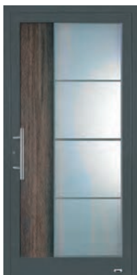
5460 Verglasung: Wärmeschutzisoliertes, vorne: VSG beschichtet, Mitte: ESG mattiert hinten: ESG, Oberfläche: RAL 7012 Basaltgrau FS Applikation: An Teak
